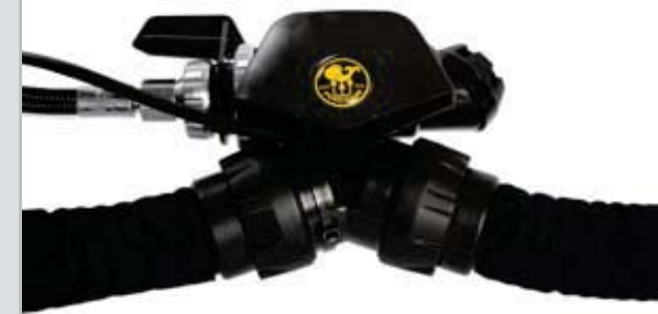
Das Mundstück: Mit dem Walzenschieber wird problemlos auf das Bailoutsystem umgeschaltet.
